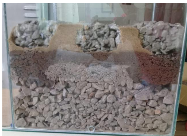
Figura 3: Experimento mostrando o pavimento permeável
