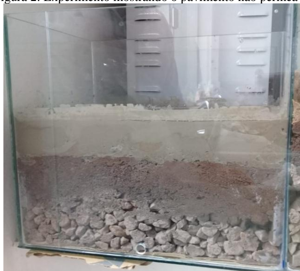
Figura 2: Experimento mostrando o pavimento não permeável
